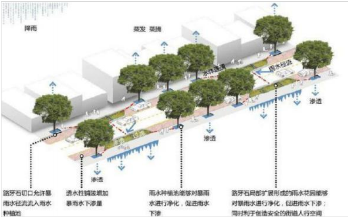
图 5.5-9 道路低影响开发设施的选择与应用示意图
