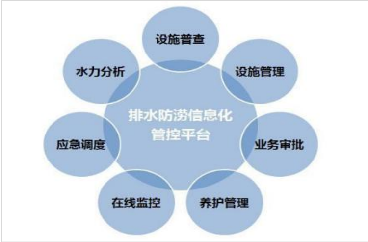
图 10-2 城市排水防涝信息化管控平台构成
