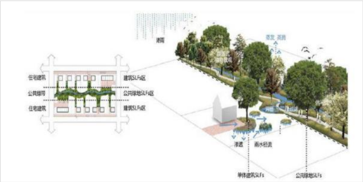
图 5.5-8 建筑与小区低影响开发设施的选择与应用示意图
