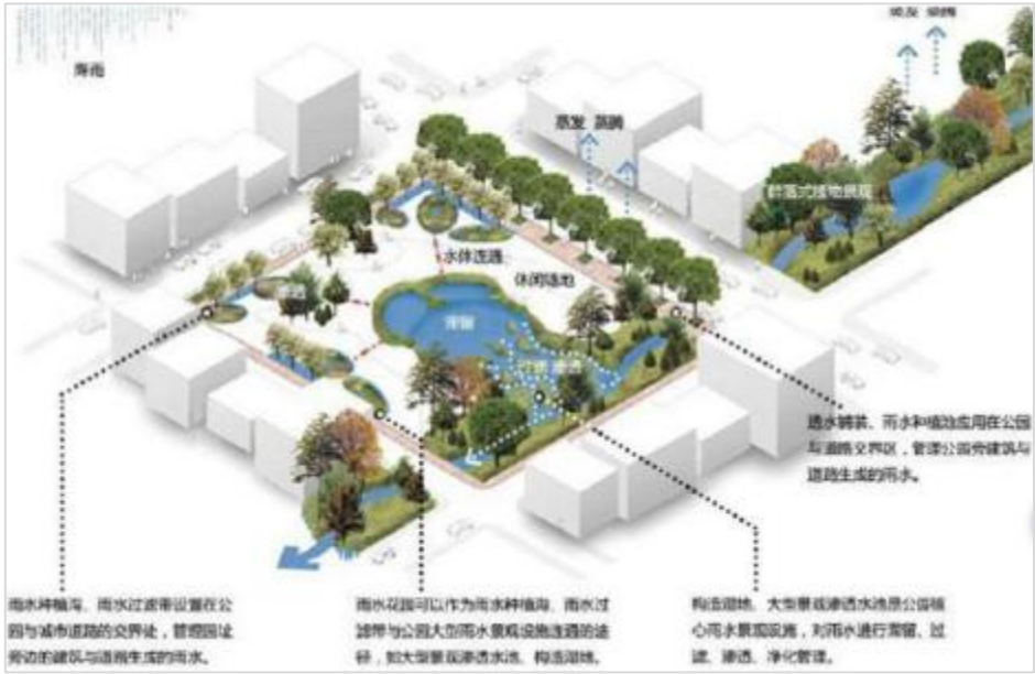
图 5.5-10 城市绿地与广场低影响开发雨水系统典型流程图
