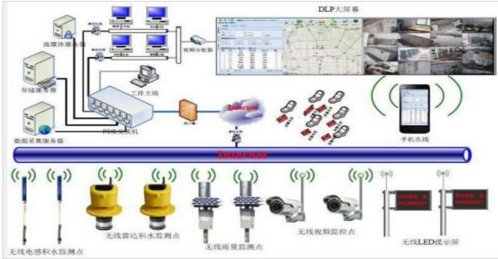
图 10-4 城区积水监控平台
