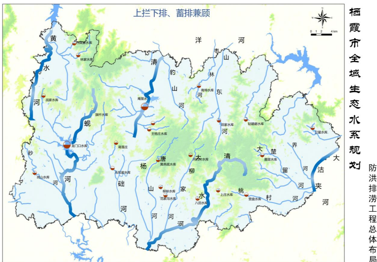
图 4.3-1 防洪排涝工程总体布局图
